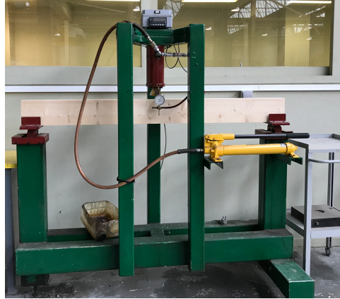
Figure 3. Dispositif expérimental de la poutre en flexion 3 points.
